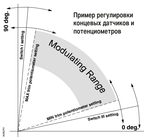
Рис. 13. Установка кулачков и подстроечных потенциометров.
